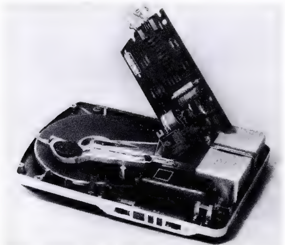
Bild 6. Traveller ohne Gehäuse mit herausgeklapptem Transistorverstärker
